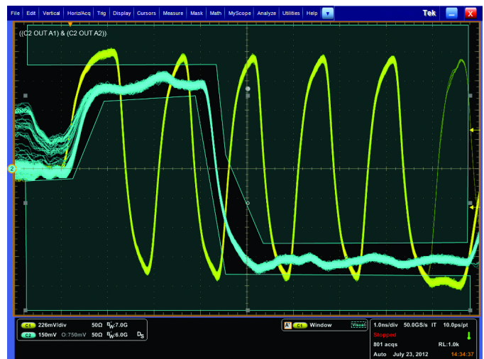
DDR-Speicher. Visueller Trigger zum Isolieren eines selten auftretenden Schreib-Bursts in einem bestimmten Bitmuster im DDR3. Bei dem Trigger-Ereignis handelt es sich um einen DQ-Schreib-Burst 11000000 zu Beginn des DQ-Aufrufs von einem Non-Tri-State-Spannungswert. DDR-Speicherbus-Ereignisse umfassen Takte, Strobes und Datenkanäle sowie Mehrfach-Amplituden und Daten-Bursts.
