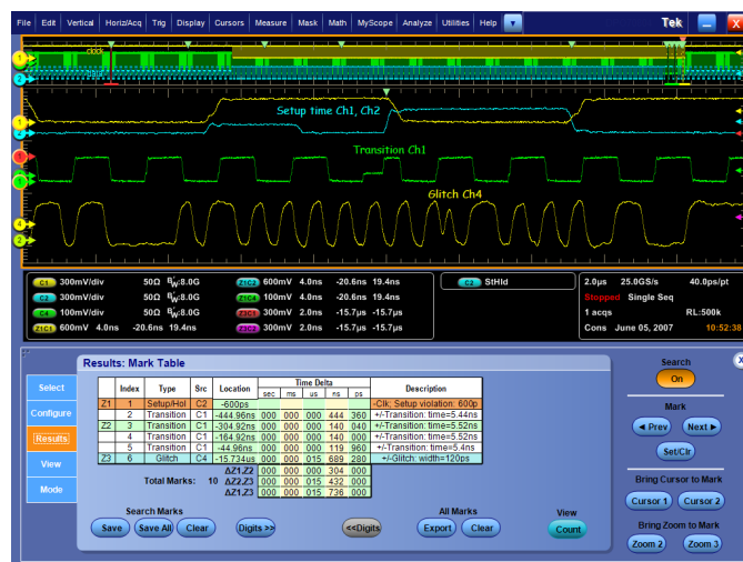
Erweiterte Such- und Markerfunktion – Zum Markieren von wichtigen Ereignissen. Vor- und Zurück-Schaltflächen sowie Mausklicks ermöglichen die mühelose Navigation zwischen den zu untersuchenden Ereignissen.
