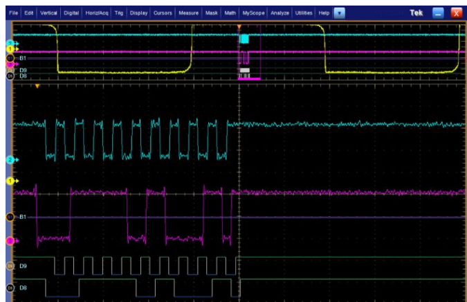
Integrierte Logikkanäle – Bieten zeitkorrelierte analoge und digitale Sichtbarkeit für die Fehlerbeseitigung des Systems.
