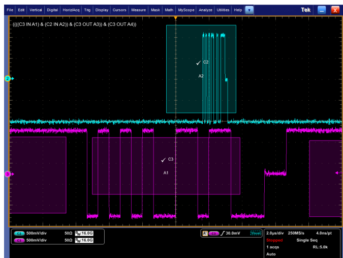
Mehrkanal-Triggerung. Visuelle Triggerbereiche können kanalübergreifenden Ereignissen, wie z. B. auf zwei USB2.0-Bussen gleichzeitig übertragenen Paketen, zugeordnet werden.
