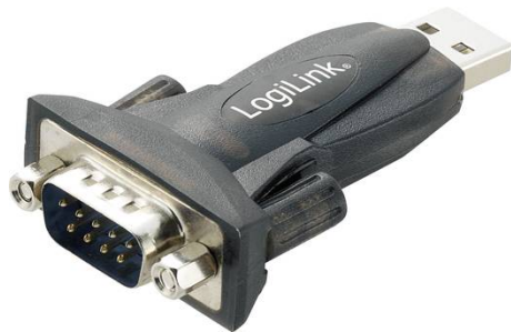
Abb. 12.37: Adapter von USB auf RS-232 von LogiLink.
