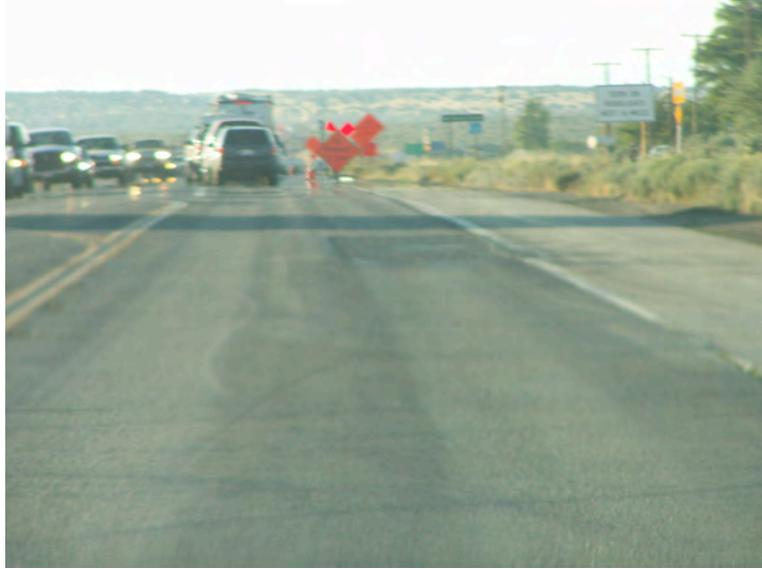
**Abb. 1.8:** Luftspiegelung auf einer trockenen Strasse. Die Spiegelung ist nur für sehr kleine Auftreffwinkel, d. h. für die Scheinwerfer der weit entfernten Fahrzeuge zu sehen.
